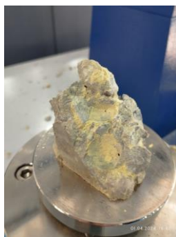
4-rasm. Kub shaklidagi namunalarni siqilishga sinash
