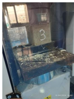
4-rasm. Kub shaklidagi namunalarni siqilishga sinash
