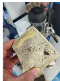
Oltिंगugurt beton namunalarni laboratoriya sharoitida fizik-mexanik sinovlari natijalari
