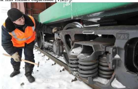
1-rasm. Vagonlarni tarkibdan ajratmasdan texnik ko'rikdan o'tkazish jarayoni
