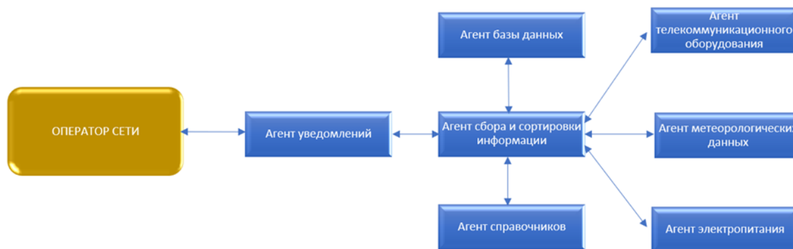
Рис.1. Модель сетевой системы мониторинга на основе многоагентной технологии
