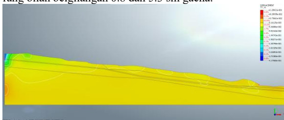
4-rasm. Seysmik ta'sirni hisobga olgan holda quruq yonbag'irning kuchlanganlik-deformatsiyalanganlik holatini (KDH) hisoblashda Y o'qi bo'ylab siljish izomalari
