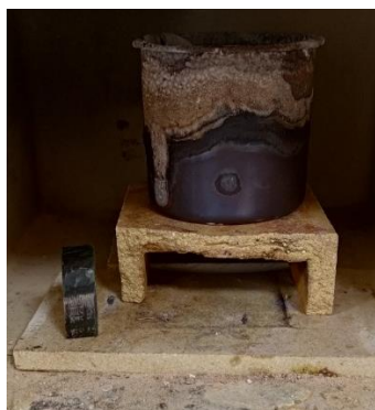
Рис. 2. Образец и стальной тигель в муфельной печи
