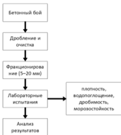
Рис. 2. – Схема методологии экспериментального исследования вторичного бетонного щебня
