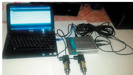
Рис. 2. Аппаратура для измерения давления в гидросистеме трактора
