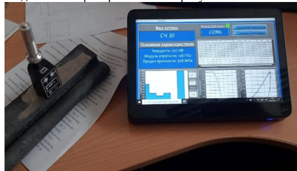
Рис. 4. Измеритель физико-механических характеристик чугуна ИФМХ-Ч
