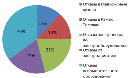
Рис. 1. Распределение отказов электровозов ВЛ80 и ЗВЛ80с по данным локомотивного депо “Узбекистан” и “Узбекистан темир йуллари” АО преимущественно в период 2017-2022 гг.
