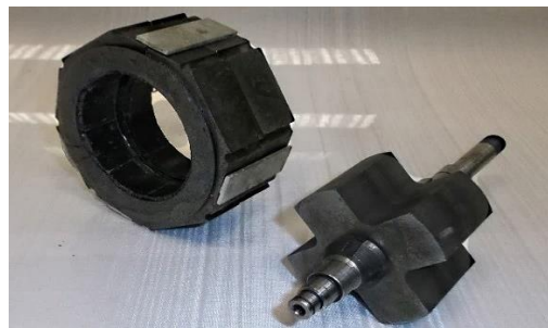
5-rasm. Kukun metallurgiyasi asosida ishlab chiqilgan magnit yumshoq kompozision materiallardan tayyorlangan stator va rotor konstruksiyasi
