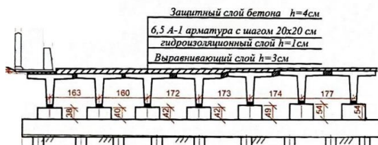
6-Rasm. Yo'l o'tkazgichning kengaytirilgan qismi 1-oraliq qurilmasining ko'ndalang kesimi
