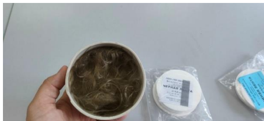
Рис. 4. - Распушенные базальтовые нити в качестве фильтрующего элемента
