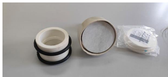
Рис. 5. - Подготовка бумажных фильтров (с черной лентой) использованию в качестве фильтрующего элемента
