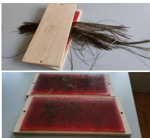
Рис. 2. - Подготовка базальтовых нитей к использованию в качестве фильтрующего элемента
