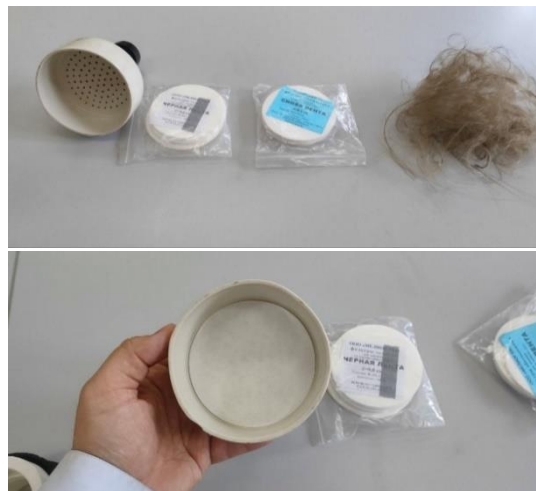
Рис. 3. - Подготовка бумажных фильтров (с синей лентой) использованию в качестве фильтрующего элемента
