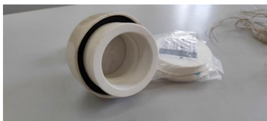
Рис. 6. - Уплотнительные кольца для соединения фильтровальных слоев
