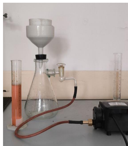
Рис. 8 - Лабораторная установка для регенерации антифриза
