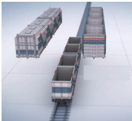
4-rasm. Bitta platformada turli xil almashimuvchi kuzovlarni joylashtirish ko'rinishi
