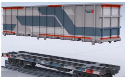
3-rasm. Yarim ochiq vagonlarda yuk tashish uchun mo'ljallangan almashimuvchi kuzov
