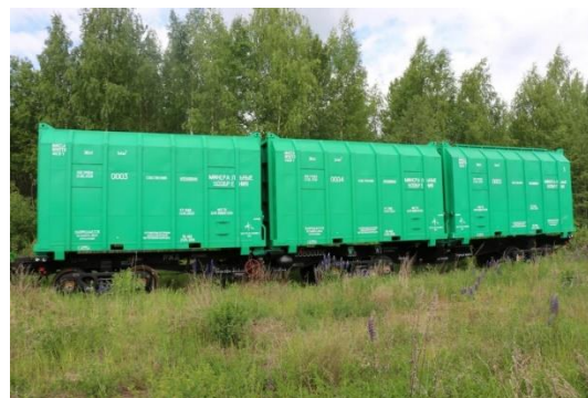
2-rasm. Yopiq vagonda yuklarni tashish uchun mo'ljallangan almashinuvchi kuzov
