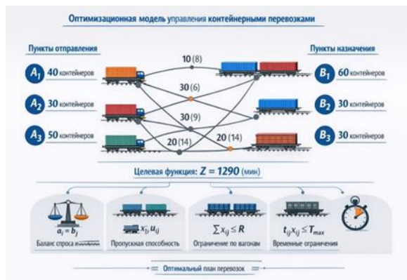
Рис. 3. Оптимизационная модель управления контейнерными перевозками
