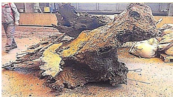
2-rasm. Pechdan chiqarilgan shlak-metall konglomerati Pechdan chiqarilgan shlak-metall konglomerati taxminan 2,5 tonna og'irlikka ega bo'lib, u IBT ulushi yuqori bo'lgan metall shixtani qayta ishlash jarayonida uzoq muddatli ekspluatatsiya natijasida hosil bo'lgan.
