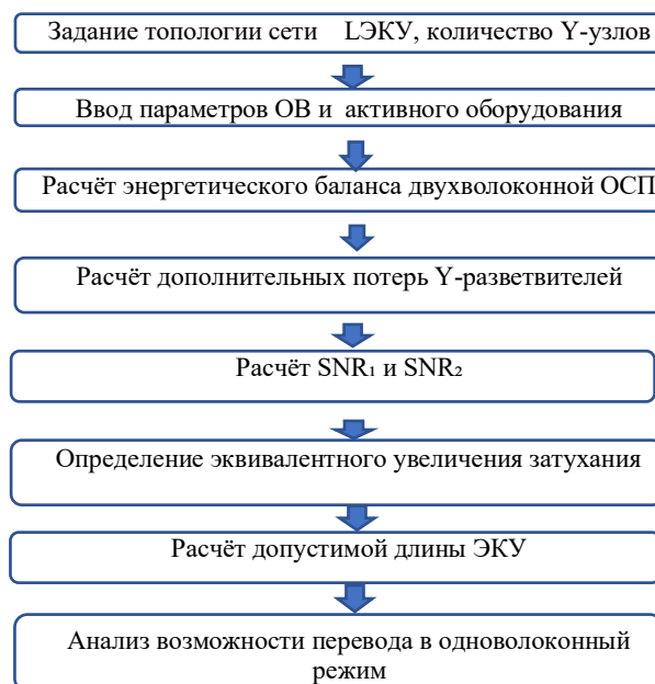
Рис. 1. Структурная схема алгоритма моделирования разветвлённой сети
