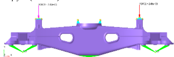
3-sxema. Balkaning sirpanish kronshteynlariga navbatma-navbat P_{(sk)} = P_0 kuch ta'siri
