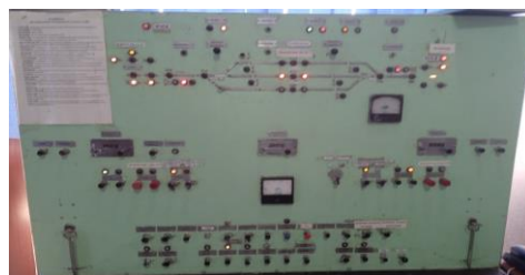
3-rasm. UP-1 va UP-2 turidagi takomillashtirilgan (unifitsirovanni) pultlar
