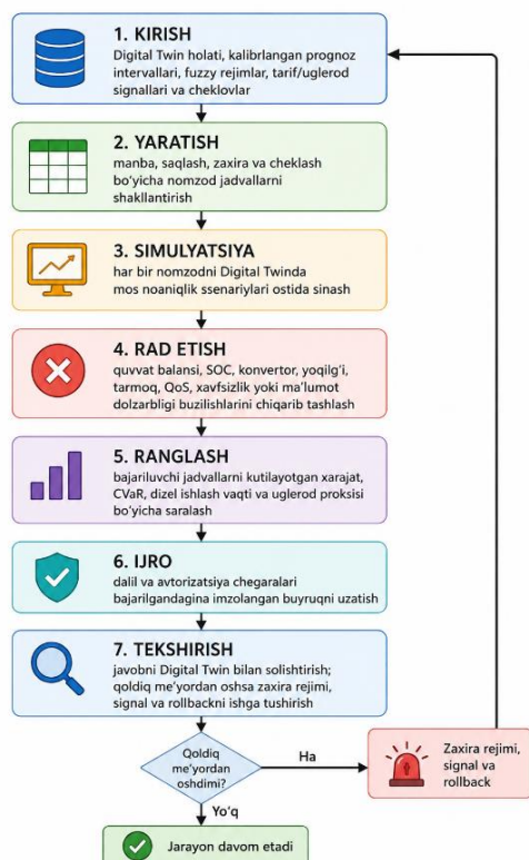
7-rasm. Xavfni hisobga oluvchi dispatcherlik va tekshirilgan ijro algoritmi
