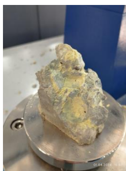
4-rasm. Kub shaklidagi namunalarni siqilishga sinash
