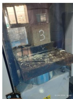
4-rasm. Kub shaklidagi namunalarni siqilishga sinash
