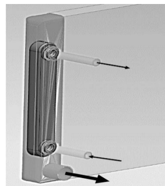
4-rasm. Avtomatik uzatmalar qutisi moy sovutgichining radiator bachogidagi joylashuvi
