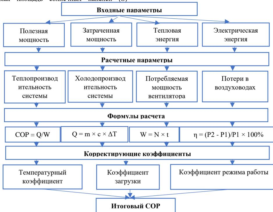
Рис. 1. Расчет коэффициента преобразования энергии (COP - Coefficient of Performance) в системах вентиляции
