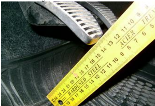
1-rasm. a) Tormoz tepkisini bosishdan avvali o'lchami
