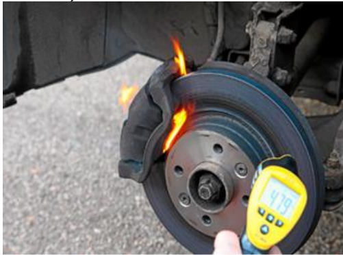
3-rasm. b) Tormozlarni juda tez qizishi
