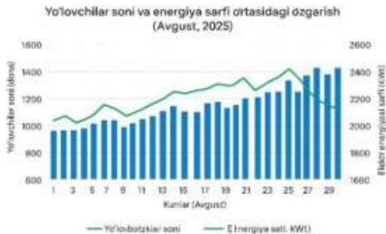
1-rasm. Avgust oyi davomida yo'lovchilar soni va elektr energiyasi sarfi o'rtasidagi o'zgarish (Urganch shahar trolleybuslari)
