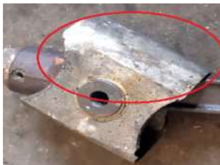
A-kreyskopfning harakatlanuvchi yuzasining yemirilishi holati, B-val yuzasining yemirilishi holati 2-rasm. Kompressorning harakatlanish mexanizmlarini yemirilish holati ko'rinishi
