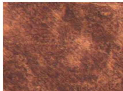
2-rasm. 35G2RPS po'latining struktura tuzilishi
