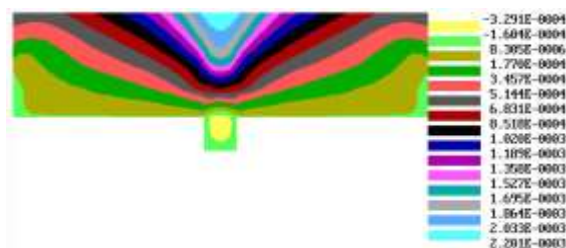
Рис. 3. Результаты расчета. а) расчетная схема, б) горизонтальные перемещения (м), в) вертикальные перемещения (м)
