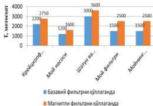
7-rasm. Bazaviy va magnitli moy filtni qo'llaganda kompressor qismlarining ish resurslari
