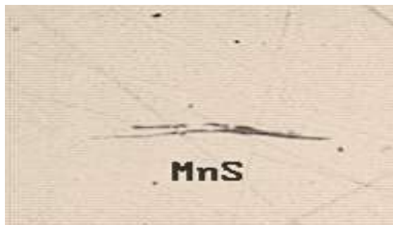
3-rasm. Po'lat stukturasiidagi marganes sulfidlari (1-tip Sims bo'yicha)
