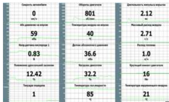
2-rasm. Avtomobil OBD II parametrlarini to'plash uchun dasturiy interfeys
