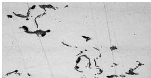
2-rasm. Po'lat strukturasiidagi sulfidlar (x100)
