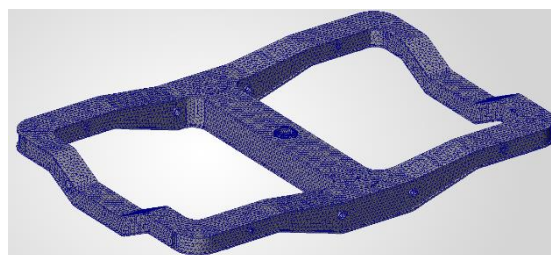
2-rasm. Telejka ramasi konstruksiyasining chekli elementlar to'ri
