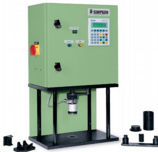
Рис. 2. Мини-лаборатория для измерения физико-механических формовочных смесей Simpson PVF-C
