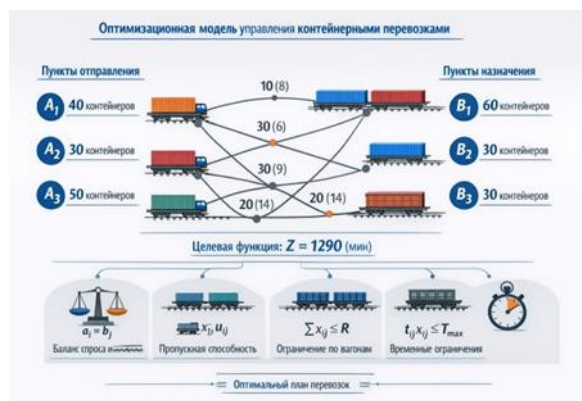
Рис. 3. Оптимизационная модель управления контейнерными перевозками
