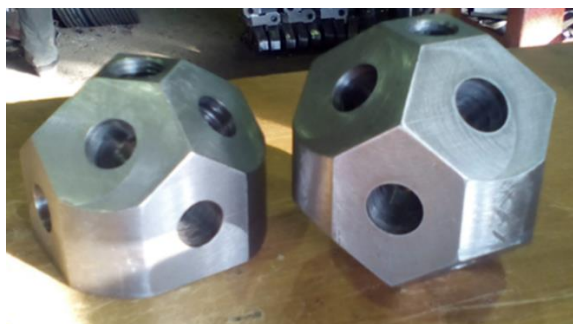
Рис. 2. Узловые элементы структуры «Кисловодск»
