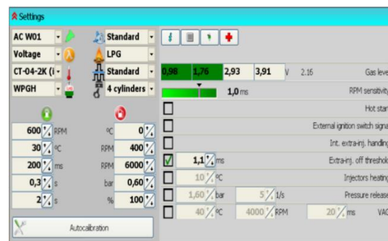
1-rasm. GBUni diagnostika dasturidagi "benzindan gazga" boshqaruvinin zavod tomonidan tavsiya etilgan universal rostdash tartibi [8]
