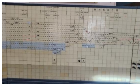
7-rasm. TVBU turidagi svetodiodli subbloklardan tuzilgan takomillashtirilgan (unifitsirovannye) blokli tashqi tablolar
