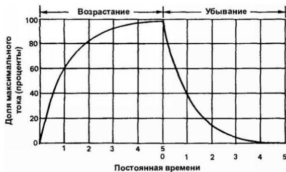
Рис. 2. График индуктивной части реле
