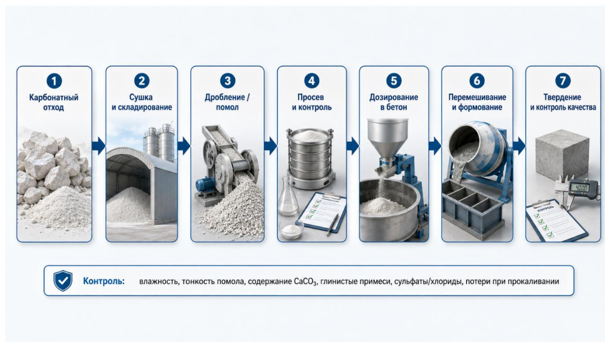
Рис. 1. Технологическая схема подготовки и применения карбонатного отхода в бетоне
