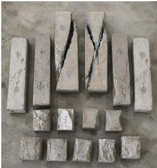
5-rasm. Beton namunalarni sinash natijasi
