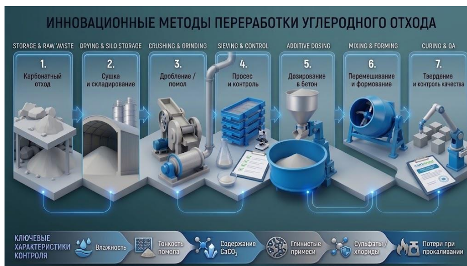
Рис. 1. Технологическая схема подготовки и введения карбонатного отхода в бетонную смесь
