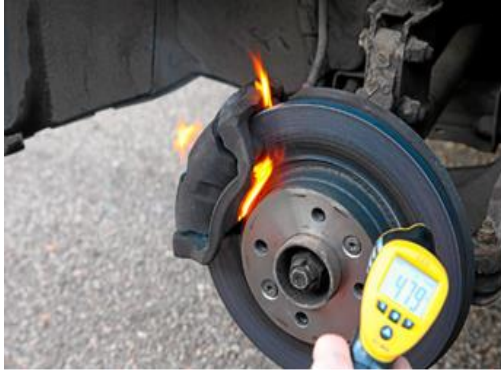
3-rasm. b) Tormozlarni juda tez qizishi
