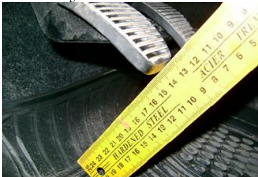
1-rasm. a) Tormoz tepkisini bosishdan avvali o'lchami
