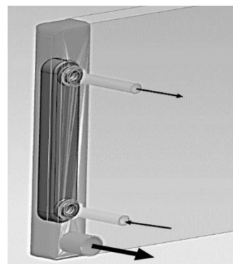
4-rasm. Avtomatik uzatmalar qutisi moy sovutgichining radiator bachogidagi joylashuvi
