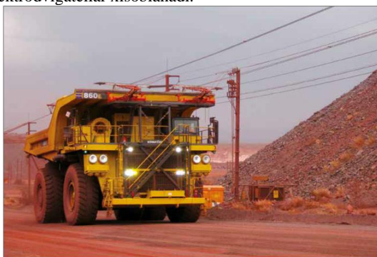
2-rasm. Komatsu 860E-1K to'liq elektr yuritmal xarakati
