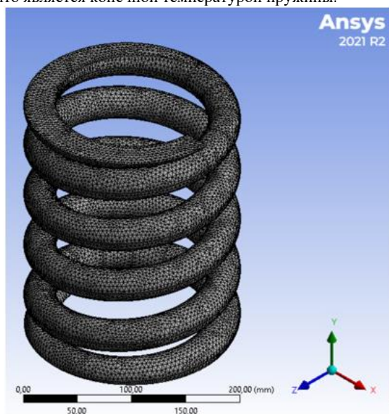
Рис. 4. Импортированная геометрия пружины и визуальный осмотр равномерности сетки
