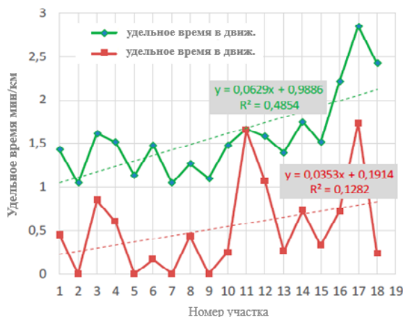
Рис. 3. Изменение технической скорости, удельного времени в движении и удельного времени простоя по километровым участкам маршрута
