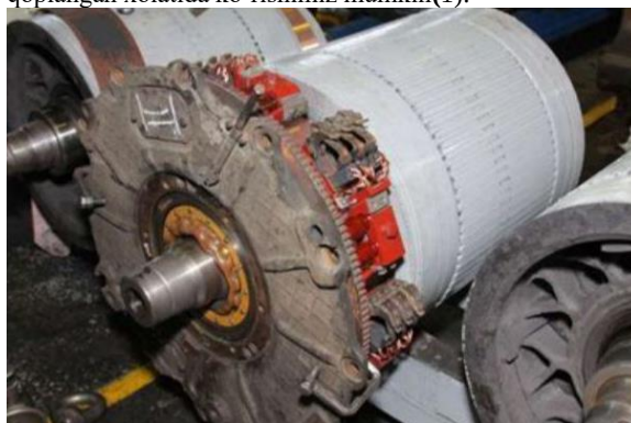
1-rasm. izolyatsiyalangan NB-418K tortuv elektro dvigateli yakori va uni izolyatsiya bilan qoplangan xolatida
