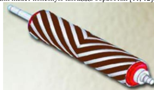
Рис. 9. Винтовой шлифовальный рабочий вал
