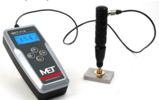
1-rasm. MET-UDA kombinatsiyalangan mikro qattqlikni o'lchash uskunasi asosiy ko'rinishi
