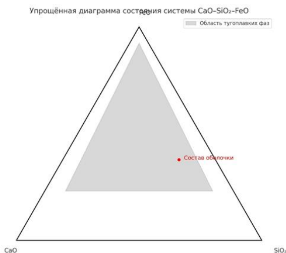
3-rasm. CaO-SiO 2 -FeO tizimining soddalashtirilgan fazaviy diagrammasi [6]
