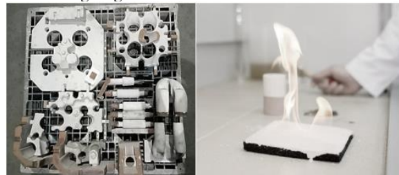
1-rasm. Qolip va o'zaklarni yuzasiga kuyishga qarshi (Zirkofluid 3139 KBV) qoplamasi
