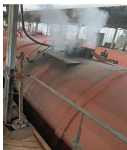
vagon-sisternalarni bug' bilan yuvish jarayoni
